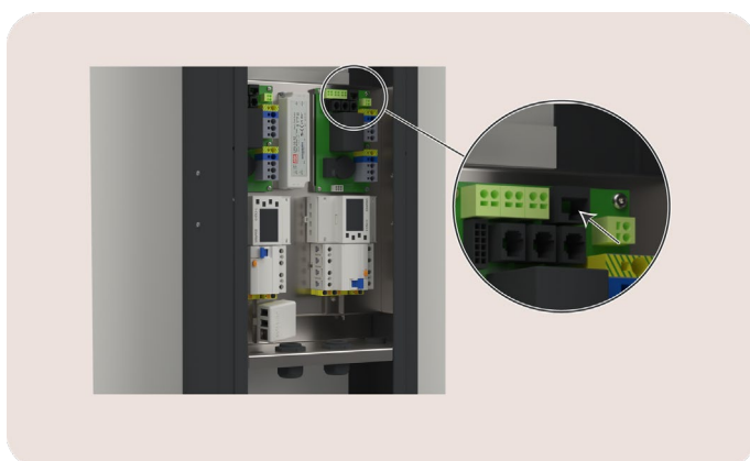
Afbeelding 17: aanzicht op de A+B-poort van het relaisbord
