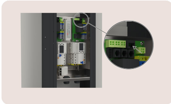
Afbeelding12: aanzicht op de A+B-poort van het relaisbord
